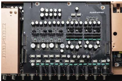
W sekcji przedwzmacniacza pracują firmowe moduły HDAM.
