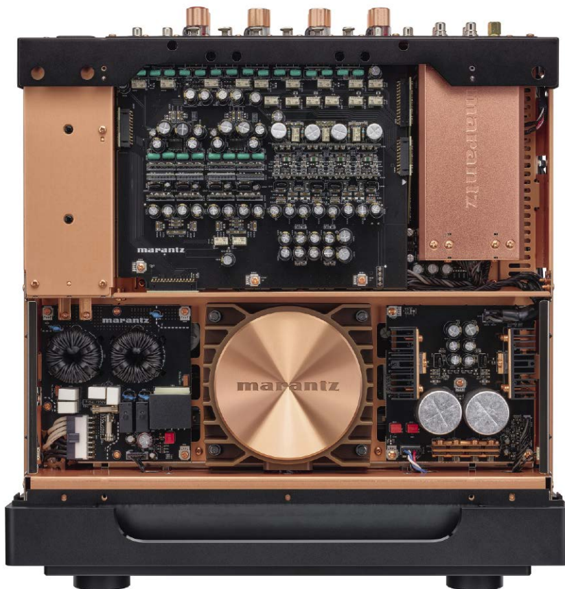
Model 10 jest jednym z najbardziej okazałych wzmacniaczy z impulsowymi końcówkami mocy, których wydajność wykorzystuje się zwykle do zmniejszenia gabarytów urządzenia. Transformator zasilający sekcję przedwzmacniacza umieszczono w miedzianej osłonie zintegrowanej z radiatorem.
