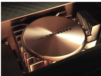
Miedzianą osłonę transformatora zintegrowano z radiatorem.
