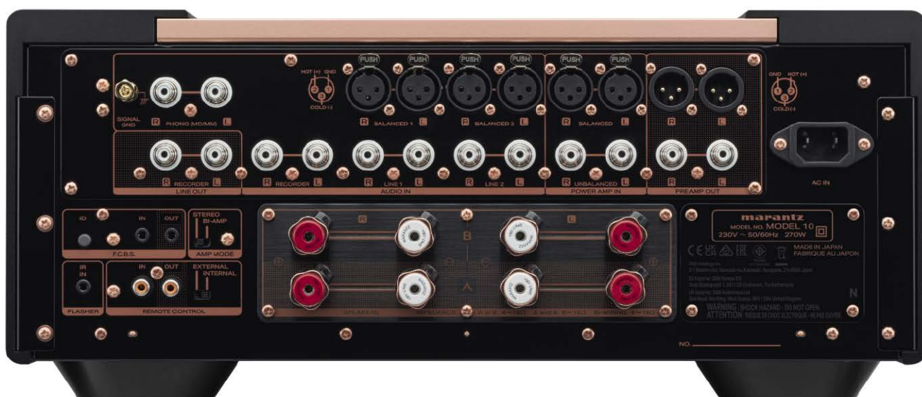
Sygnały cyfrowe trafiają do urządzeń źródłowych serii 10, wzmacniacz wykorzystuje wyłącznie technikę analogową, z czym nie kłóć się impulsowe końcówki mocy.
